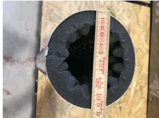
Bild 10 – Genomföringsrören hade en ytterdiameter på 115 mm och en innerdiameter på ca 70 mm.
